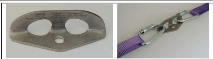
**Descripción:** Anclaje anticaídas de chapa de acero plegada. **Certificado EN795:2012 tipo A** y según especificación técnica para anclajes anticaídas multiusuario **CEN/TS16415**
